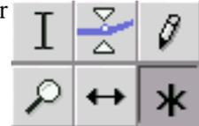
durchgeführt werden. Bei den folgenden Erläuterungen wird davon ausgegangen, dass der „Sternchen-Knopf“ aktiviert ist. (Mit den anderen Werkzeugen könnten gezielt einzelne Bearbeitungsmodi eingeschaltet werden.) Mit dem Multifunktionswerkzeug erhält die Maus drei unterschiedliche Funktionalitäten je nach Standort auf der Wellendarstellung:
